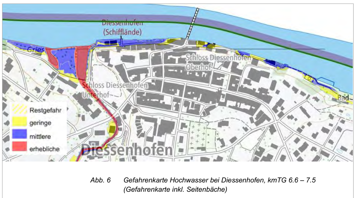
Abb. 6: Gebiete mit Hochwassergefährdung gemäss Bericht Ufersanierung Hochrhein
